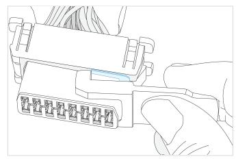
Remova as presilhas metálicas do adaptador puxando-as usando a extremidade de remoção da ferramenta de inserção/remoção.
