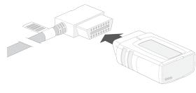
4 Conecte o conector OBDII macho do chicote ao conector OBDII do veículo removido na Etapa 1.
