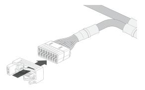
2 Insira o adaptador pequeno de encaixe no fio atrás do conector.
