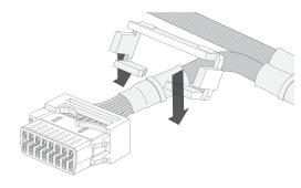
3 Deslize o adaptador pequeno de encaixe a partir da parte de trás do chicote. Verifique se o adaptador está intertravado com segurança.
