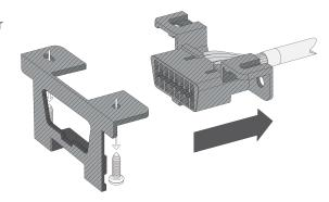
Prenda o conector universal fêmea (extremidade curta) do chicote ao adaptador apropriado (consulte a seção Adaptadores acima) correspondente à instalação necessária.
