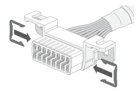
Aperte o conector universal fêmea (extremidade curta) do chicote no slot OBDII do veículo e prenda-o no lugar usando parafusos ou presilhas de plástico nos adaptadores.
